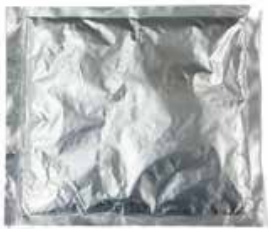
画像: アルミ袋に封入した潜熱蓄熱材の外観 (1パック)
